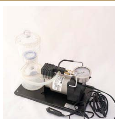
Bombas de filtrado de metales disueltos
